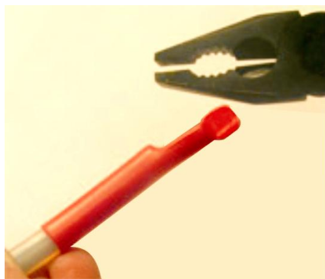
4.Обжать край термоусаживаемой трубки для изоляции.
