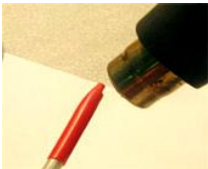
3. Изолировать с помощью термоусаживаемую трубки
